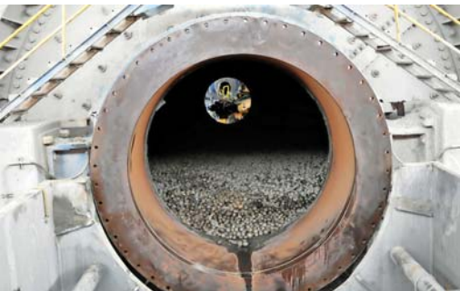
En la minería, las bolas de acero son utilizadas durante el proceso de molienda de la roca extraída, comúnmente dentro de molinos.
